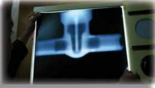
**Equipo para Examinación Radiográfica.** **WALWORTH** cuenta en sus instalaciones con su propia fuente de Iridio Ir-92, para las pruebas de radiografía a las fundiciones desde 0.100" hasta 2 1/2" de espesor de pared, verificando la sanidad de las materias primas.
