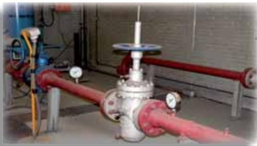
**Circuito de Pruebas.**- Se cuenta con un laboratorio completo para la validación de diseño, simulando las condiciones de operación más severas. La duración de una prueba es de 4 a 6 meses, tiempo en el cual se realizan de 3000 a 5000 ciclos (apertura y cierre).
