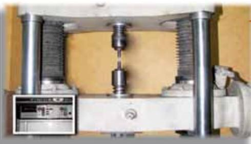
**Equipo de Prueba de Tensión.-** Para asegurar las propiedades mecánicas de los materiales empleados en la fabricación. WALWORTH realiza pruebas por muestreo de probetas de las materias primas provenientes de nuestros proveedores, aún cuando se reciban certificaciones de calidad de las mismas.
