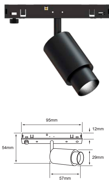
MAGNET SPOT AJUST I NUEVO 2YSMLED071DC30N ■ Negro ● Luz cálida brillante 3 000 K POTENCIA: 2 W LUMENS: 70 lm VOLTS: 24 VCD Vida útil: 20 000 h | IRC: 90 | Ángulo: 12-50° zoom Tipo de lámpara: LED integrado Atenuable: No Dirigible
