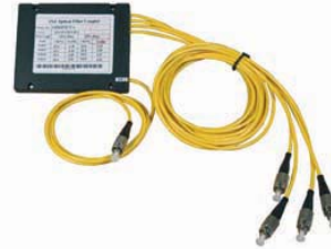
TOS 04 distribuidor óptico
