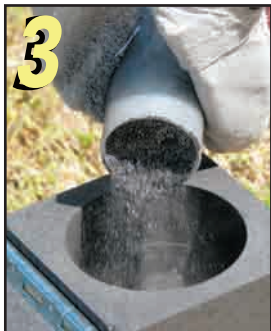
Pour powder into crucible
