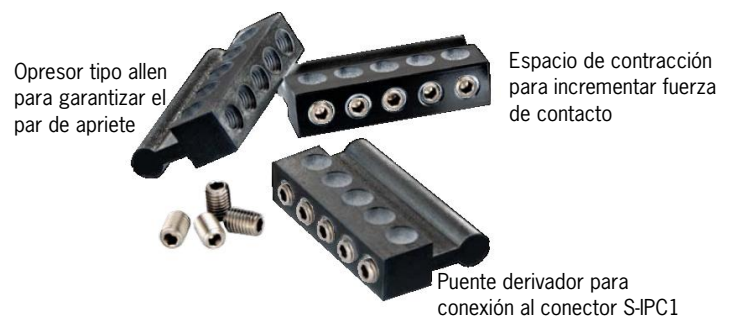
Conector S- MC con adaptador (aislado)
