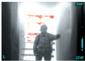
Imágenes de baja sensibilidad en la pantalla de una TIC E5200HD 2
