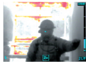
La misma imagen con Zoom 2X digital activado que muestra imágenes de baja sensibilidad en la pantalla de una TIC E5200HD 2
