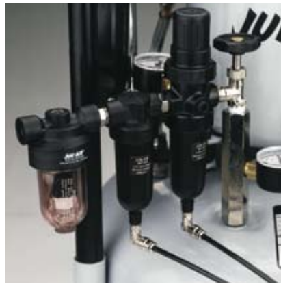
Filtros montados en un compresor
