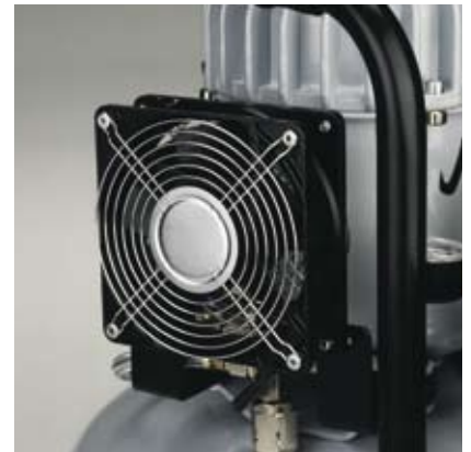
Ventilador montado sobre un compresor
