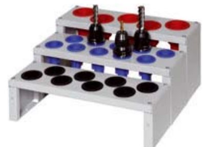
Bastidor modular atornillado, con diferentes alojamientos
