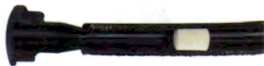
PROYECTIL DISPARADO A TRAVÉS DE MANGUERAS HIDRÁULICAS
