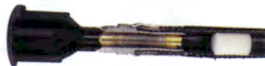
PROYECTIL DISPARADO A TRAVÉS DE MANGUERAS HIDRÁULICAS CON ACOPLES
