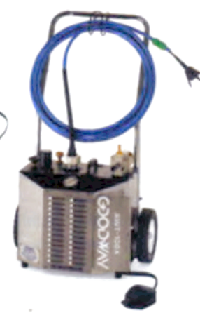
Limpiador de tubos accionado por aire, para servicio pesado
