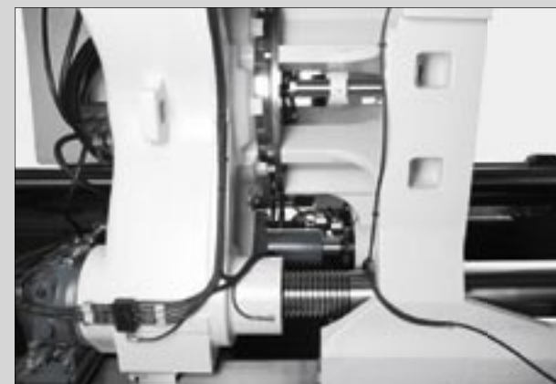
Posicionamiento de la altura de montaje del molde con pistón de poco mantenimiento y engrase central para la unidad de cierre
