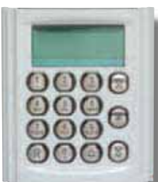
Art. 8017 Modulo comando con tastiera e display per apertura serratura con codifica, fornito di un'uscita a relè per apertura serratura e di 3 uscite supplementari per pilotaggio di relè tipo art. 170/001. I codici per l'apertura serratura possono essere inseriti tramite tastiera (100 codici diversi) o per mezzo delle chiavi art. 89TK (500 codici diversi) interfacciabili con moduli 80TK. Al modulo 8017 si possono collegare fino a 4 moduli 80TK indipendenti. È fornito di software per la gestione supplementare del modulo con un PC. Per l'interfacciamento con PC si richiede l'art. 6952. Richiede alimentatore tipo art. 6582 e telai tipo art. 8D81, 8D82, 8D83, 8D84.
