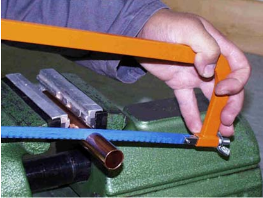
Rohre rechtwinklig absägen Rectangularly saw off the pipes Scier le tube à angle droit
