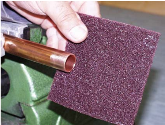
Rohr metallisch blank reinigen Clean to a bright metallic finish Nettoyer jusqu'au métal nu
