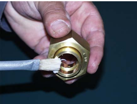
Flußmittel am Lötteil auftragen Apply the soldering flux at the part to be soldered Appliquer le fondant au point à braser
