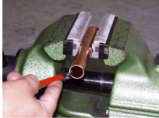
Rohrende innen und außen entgraten Deburring of the pipe extremities inside and outside Ebarber les extrémités du tube à l'intérieur et à l'extérieur
