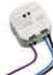
RF265625 Actuador "dimmer" 250W incandescencia y diólicas con transformador electrónico. No usar con transformadores ferromagnéticos.
