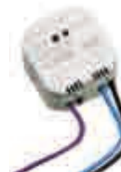
RF265625 Actuador "dimmer" 250W incandescencia y dióricas con transformador electrónico. No usar con transformadores ferromagnéticos.
